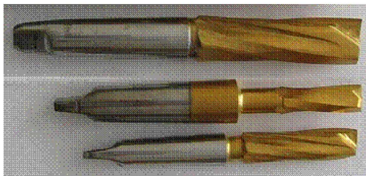
Рис. 16. Осевые лезвийные инструменты с многослойным композиционным нитрид титановым покрытием TiN – концевые фрезы производства Румынии
