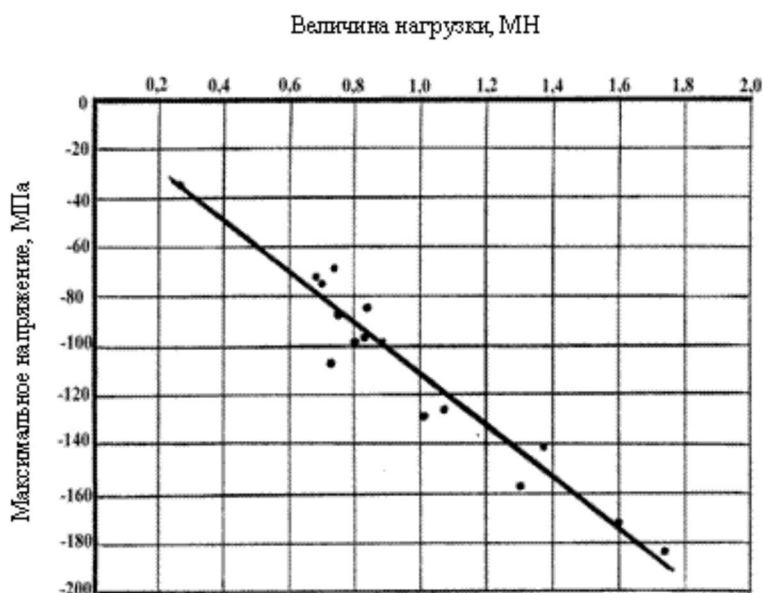
Рис. 2. Графическая аппроксимация обобщенной зависимости значений максимальных напряжений от величины усилия нагружения
