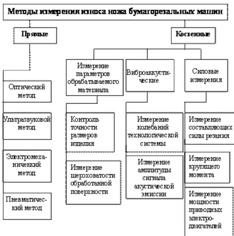
Рис. 2. Методы контроля износа бумагорезального ножа
