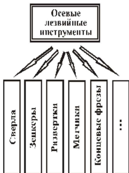
Рис. 1. Виды осевых лезвийных инструментов
