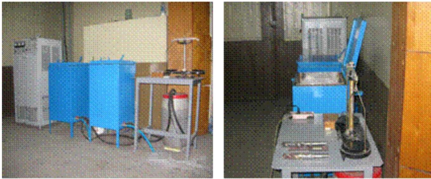
Рис. 9. Установка для комплексной ультразвуковой обработки осевых лезвийных инструментов
