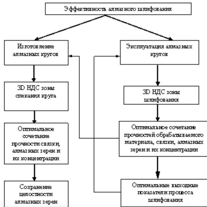
Рис. 1 – Последовательность определения оптимального сочетания прочностных свойств обрабатываемого материала, металлической связки, алмазных зерен и их концентрации
