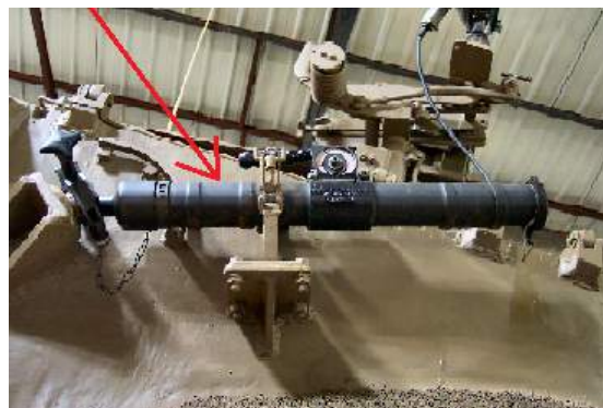
Рисунок 3 – Міномет калібру 60-мм "Soltam" на башті танка "Merkava Mk.1" (міномет вказаний стрілкою) [6]
