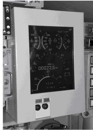
Рис. 5. Имитатор модуля КИП для тренажера
