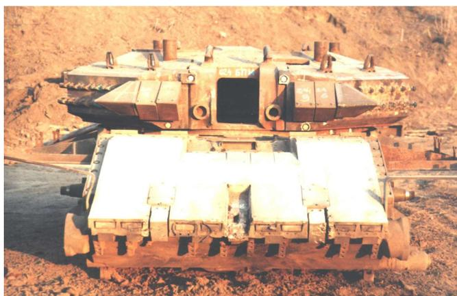
Фото 2. Носовой защитный модуль украинского танка Т-84 после воздействия ПТС
