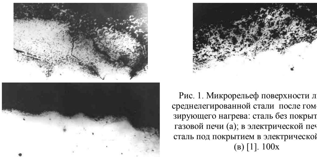
Рис. 1. Микрорельеф поверхности литой среднелегированной стали после гомогенизирующего нагрева: сталь без покрытия – в газовой печи (а); в электрической печи (б); сталь под покрытием в электрической печи (в) [1]. 100х
