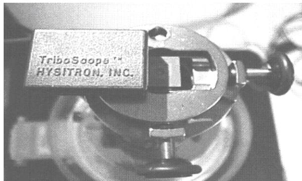
Рис. 2. Общий вид рабочего стола экспериментальной установки для осуществления процесса микроиндентации
