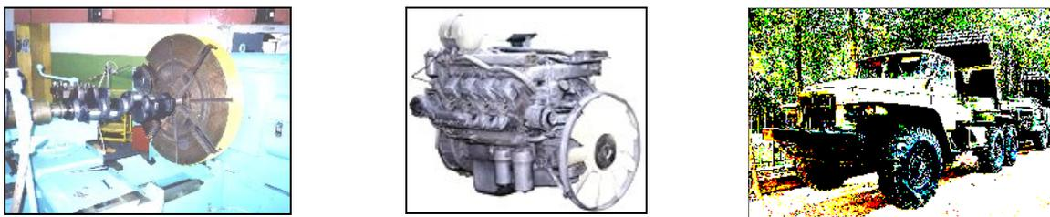
Рис. 5. Дискретно зміцнений колінчастий вал двигуна КамАЗ-740 для оснащення двигуна шасі установки «Град»
