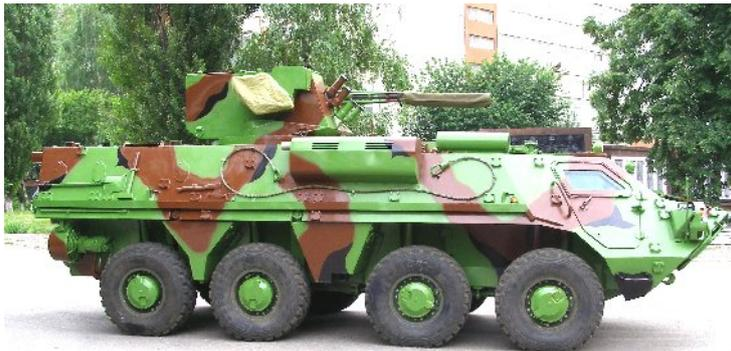
Рис. 4. Общий вид БТР-4В с двигателем DEUTZ BF 6M 1015CP и глушителем разработки ХКБМ им. А.А. Морозова
