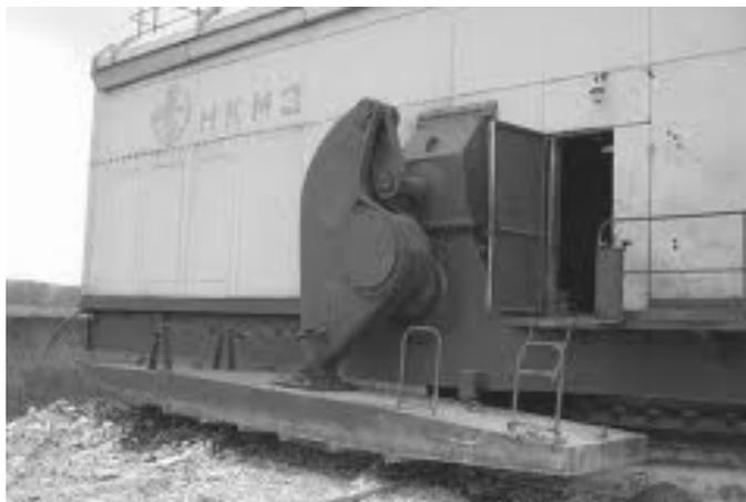
Рис. 1. Кривошипно-рычажная четырехзвенная система механизма шагания драглайна
