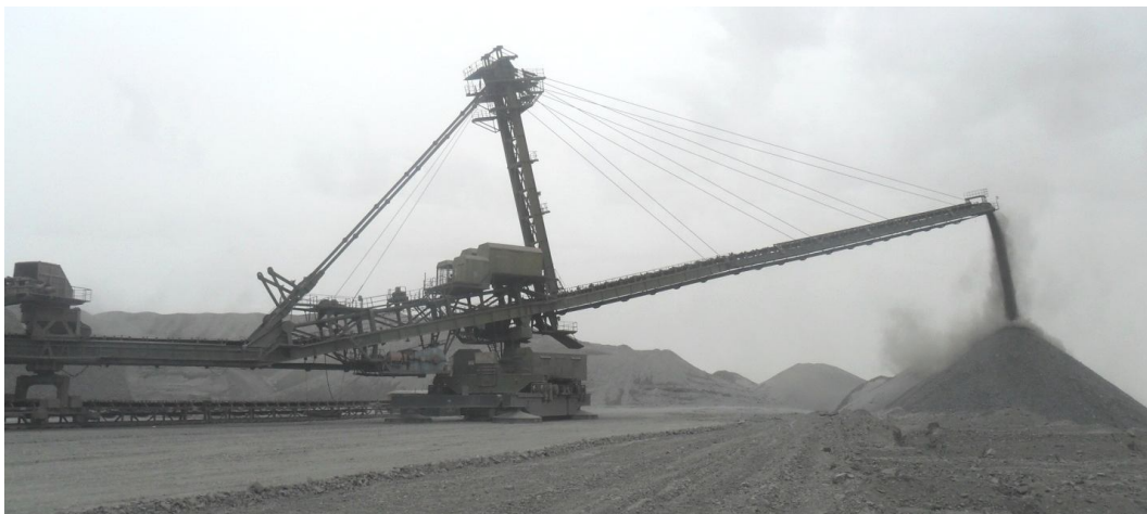
Рис.1. Отвалообразователь ОШС-4000/125 – карьер «Мурунтау»
