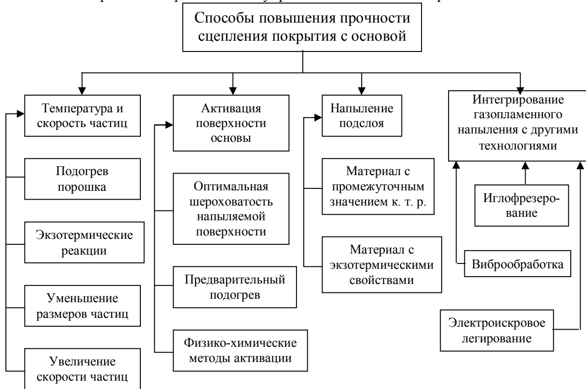
Рис. 4. Способы повышения прочности сцепления покрытия с основой
