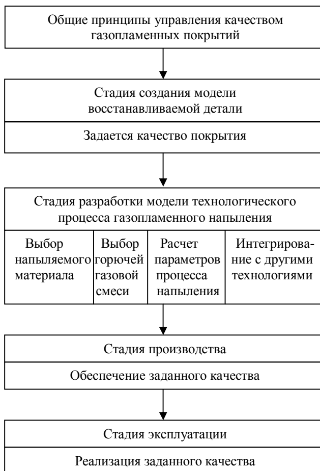
Рис. 6. Структура общих принципов управления качеством газопламенных покрытий
