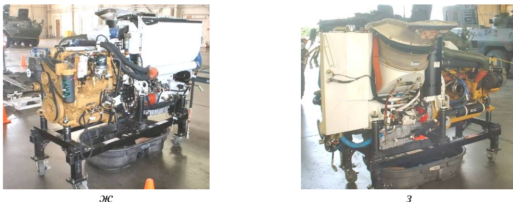
Рис. 1. Безрамное исполнение моноблоков колесных БММ: а – БТР «Pandur»; б – «GTK Boxer»; в – БТР «Fuchs»; г – БТР «LAV»; д, е – БТР «Piranha»; ж, з – БТР «Stryker»
