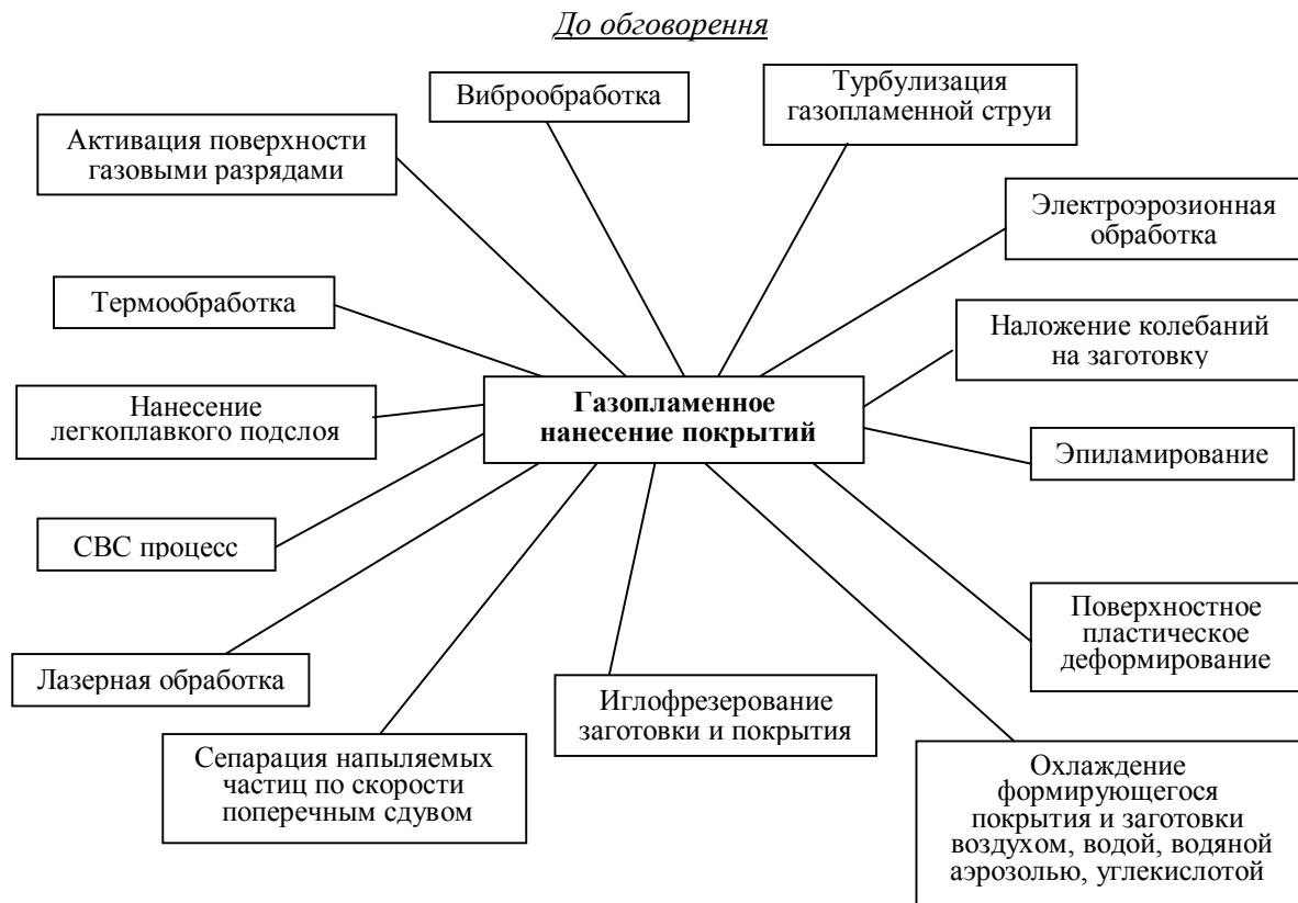
Рис. 5. Схема интегрирования газопламенного напыления покрытий с другими методами обработки поверхности
