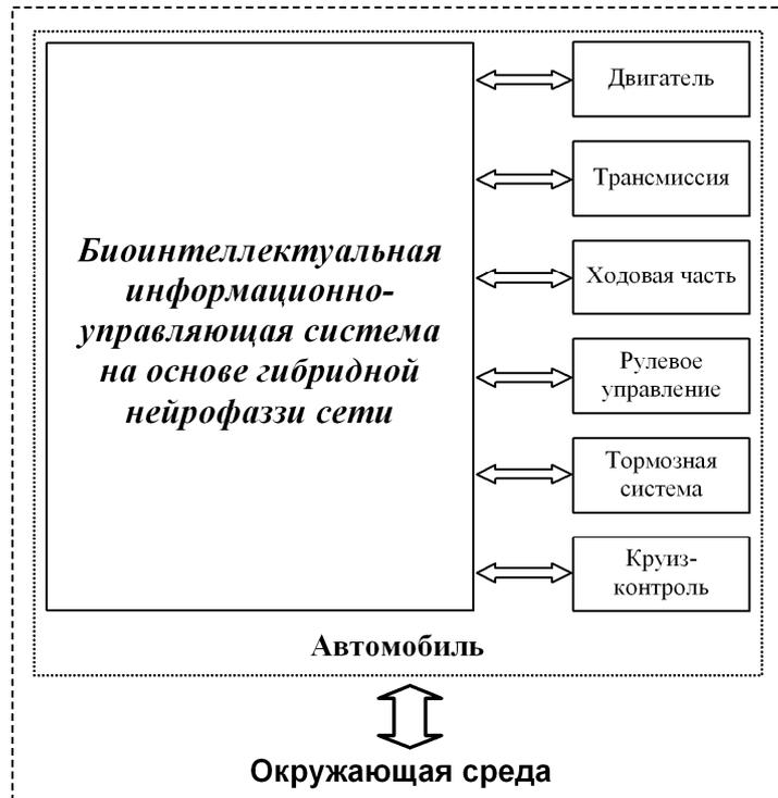
Рис. 2. Пример структурной схемы биоинтеллектуального автомобиля
