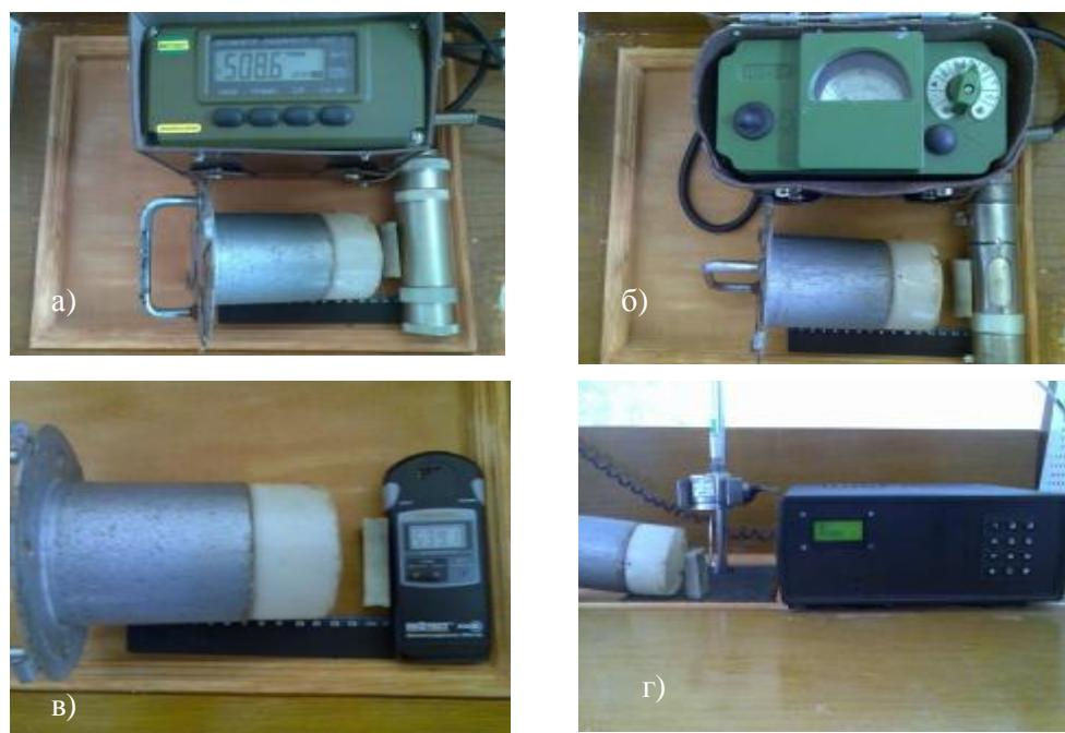
Рис. 3. Вимірювання потужності дози за допомогою приладів від джерела  $\text{Cs}^{137}$  (662 кеВ) з поглиначем ( парафін товщиною 1 см): а) МКС-У; б) ДП-5В; в) МКС-05 «Терра»; г) Лабораторна установка.
