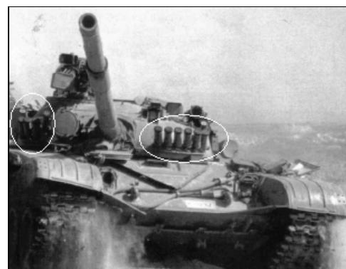
Рис.2. Пусковые установки системы постановки завесы Т-72
