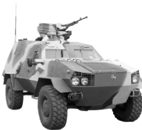
Рис. 7. Бронетранспортёр «Дозор-Б»
