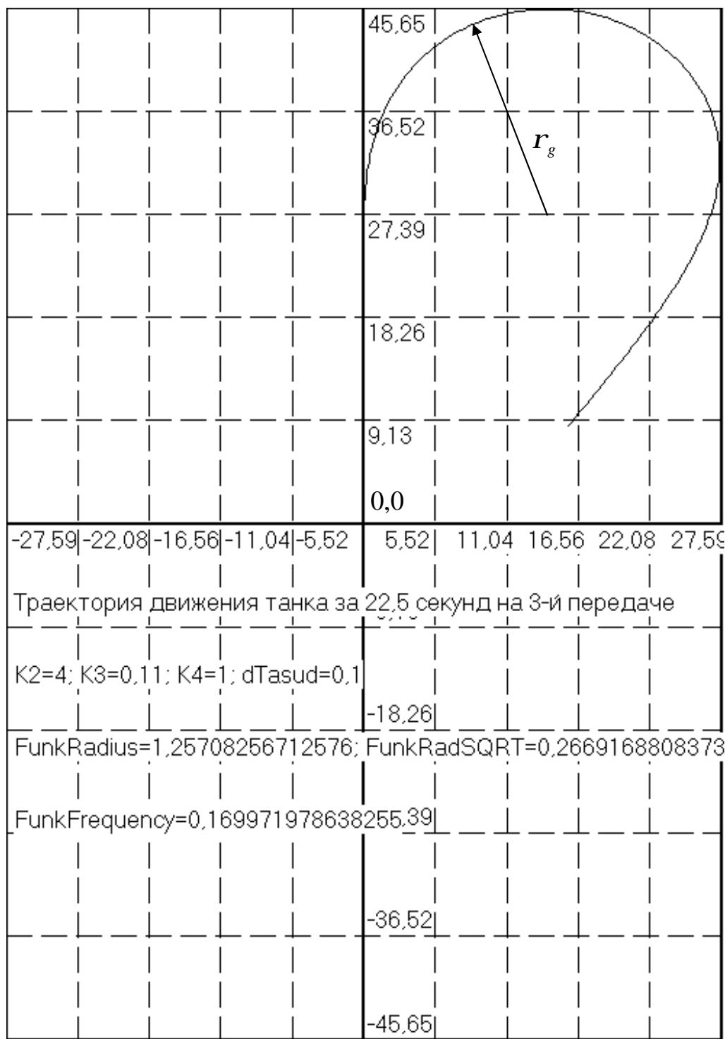
Рис. 11. Траектория движения ВГМ. Поворот вправо на третьей передаче САУП<sub>шім</sub>. Начало траектории движения в точке (0,0)
