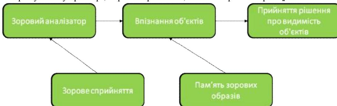
Рис.2. Модель зорового сприйняття водія
