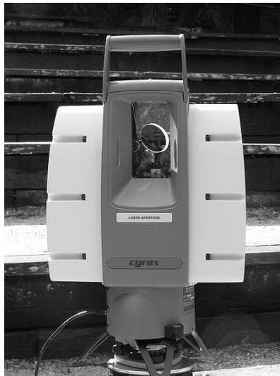
Рисунок 4 - Лидар, предназначенный для дистанционных трёхмерных обмеров зданий
